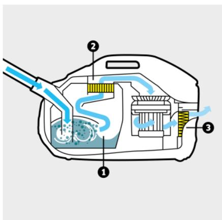
**Многоступенчатая система фильтрации:
